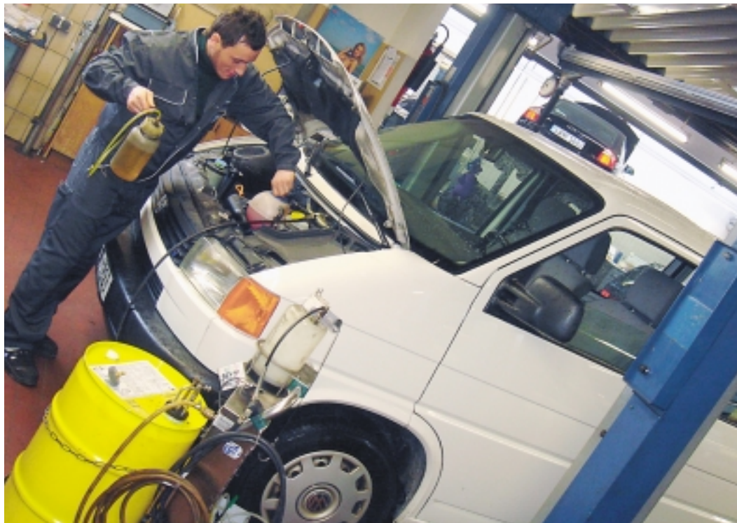
Bild 1 Weil alte Bremsflüssigkeit Wasser aufgenommen hat, was den Siedepunkt senkt, sollte sie vollständig abgesaugt werden.
