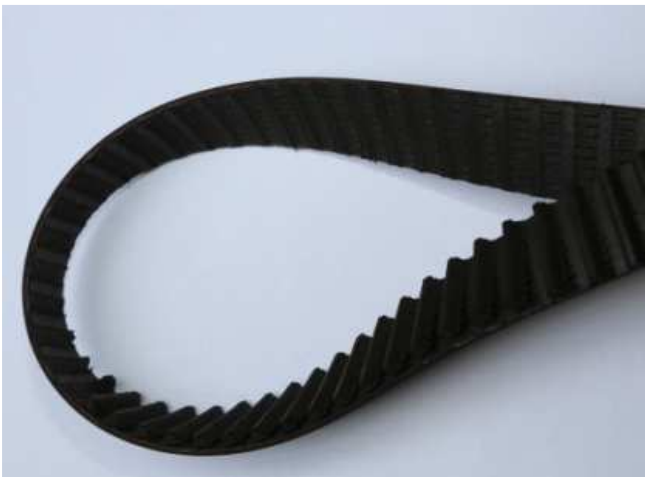
Bilder 1 + 2 Mehrere Zähne des Zahnriemens sind ausgerissen.
