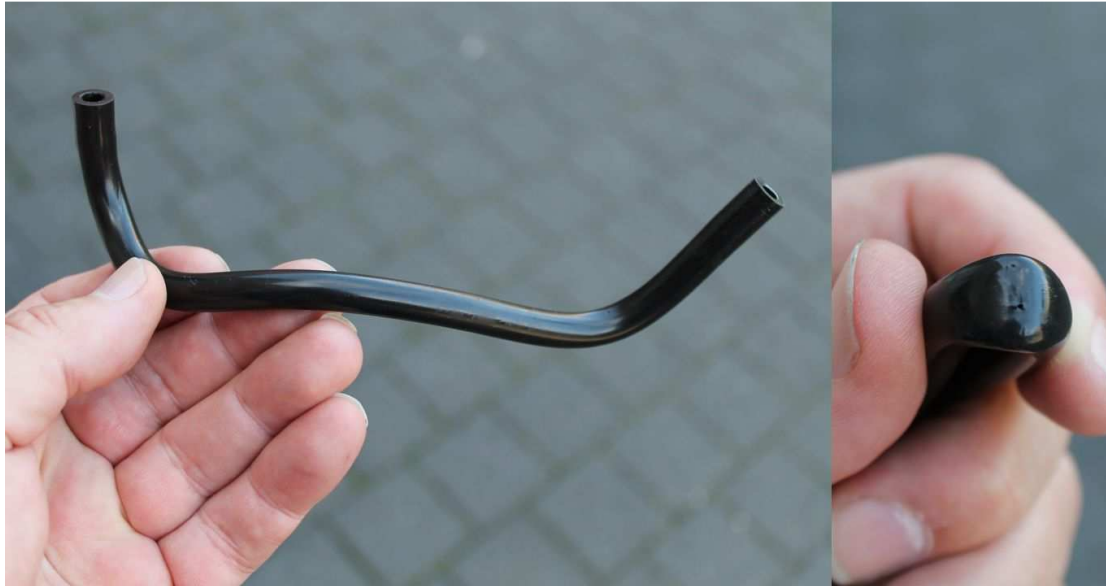
Bild 2 Ein kleiner Marderbiss in einer Unterdruckleitung war verantwortlich für die hohen Reparaturkosten.
